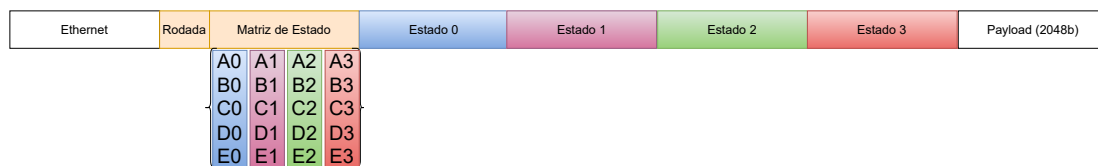
Figura 11. Esquema de cabeçalhos para cálculo de quatro estados do Forro14.
